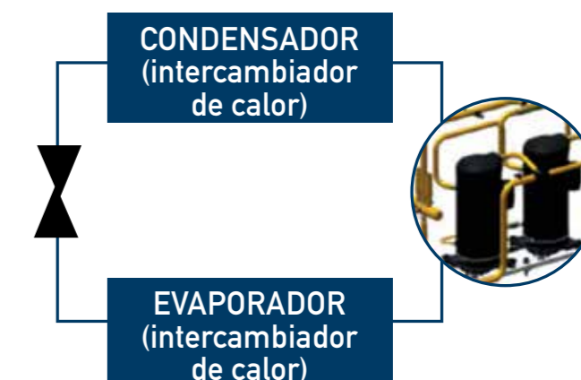
Figura 18: Elementos del circuito frigorífico ©Carrier
